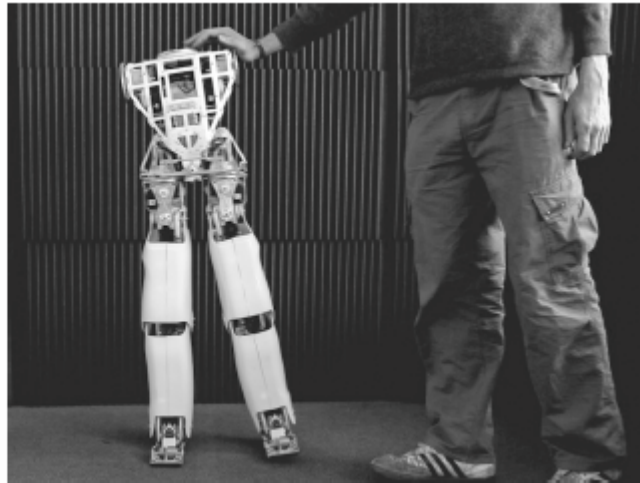
図5 左:ヒューマノイドロボットの左右の腰部駆動を制御している2つのCSL間の交差した抑制結合の概略図。右:平衡を保つ動作をしているときのMyonの下半身部分。頭と腕は付けられていない。股関節の収縮するCSLは体を圧に耐えさせ、直立姿勢を傾斜した地面に適応させる。
